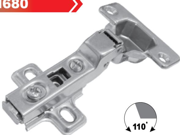
Петля мебельная четырехшарнирная цельнометаллическая системы Slide-on с углом открывания 110°. Применяется для дверей из массива дерева и древесностружечной плиты. Глубина чашки - 11,3 мм, диаметр чашки - 35 мм, расстояние от кромки навешиваемой двери до чашки петли 3-7 мм.
