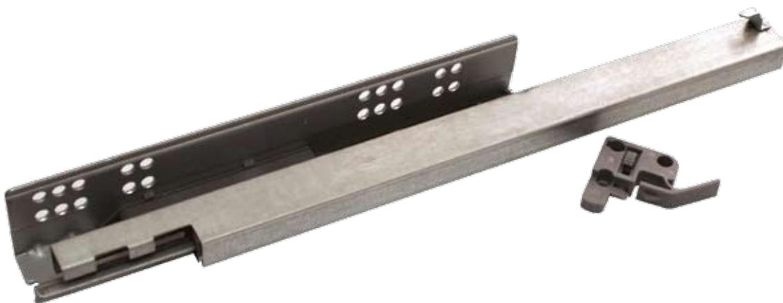
Направляющие шариковые скрытого монтажа для выдвижных ящиков. Телескопический механизм полного выдвижения, с доводчиком. Несущая способность (на пару) - до 40 кг.
