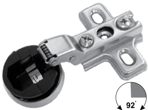
Петля мебельная четырехшарнирная цельнометаллическая системы Slide-on с углом открывания 92°. Применяется для стеклянных дверей шкафов и полок. Глубина чашки - 10,5 мм, диаметр чашки - 26мм, расстояние от кромки навешиваемой двери до чашки петли 3-6 мм.
