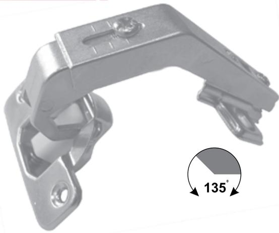
Петля мебельная четырехшарнирная цельнометаллическая системы Slide-on с углом открывания 135° для складных дверей угловых и эркерных шкафов, с фиксатором.
