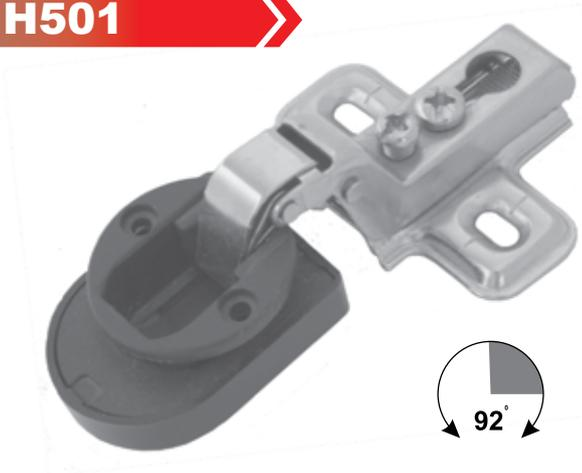
Петля мебельная четырехшарнирная цельнометаллическая системы Key-hole с углом открывания 92°. Применяется для стеклянных дверей шкафов и полок. Глубина чашки - 10,5 мм, диаметр чашки - 26мм, расстояние от кромки навешиваемой двери до чашки петли 3-6 мм.
