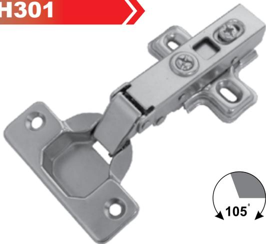
Петля четырехшарнирная системы Clip-on с газовой пружиной - доводчиком, диаметр чашки - 35 мм., глубина 11,3 мм, с углом открывания 105°.
