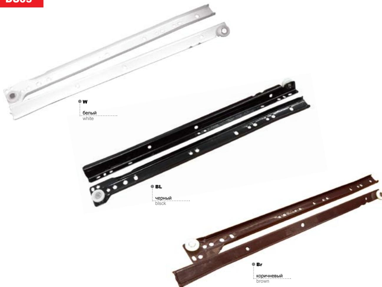
Направляющие роликовые для мебельных ящиков. Выдвижной механизм одинарный, неполного выдвижения, с самозатягиванием, двойным остановом и защитой от выкатывания. Ролик цельный, материал ролика ABS. Несущая способность (на пару) - до 10 кг. Выпускаются в трех базовых цветах: белый, черный, коричневый.
