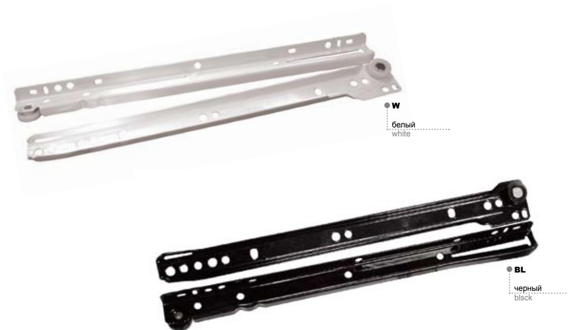
Направляющие роликовые для мебельных ящиков. Выдвижной механизм одинарный, неполного выдвижения, с самозатягиванием, двойным остановом и защитой от выкатывания. Форма профиля имеет дополнительное ребро жесткости. Ролик цельный, материал ролика ABS. Несущая способность (на пару) - до 20 кг. Выпускаются в трех базовых цветах: белый, черный, коричневый.
